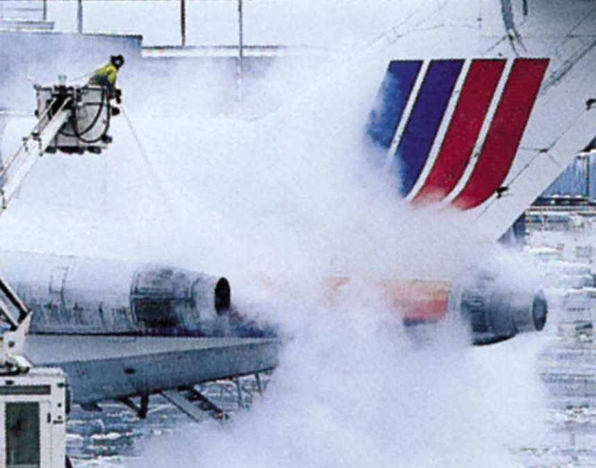
De-icing pesawat didasarkan pada penurunan titik beku
