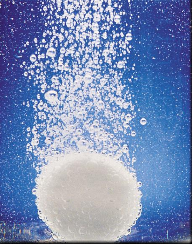
Ketika tablet Alka-Seltzer dilarutkan dalam air, ion bikarbonat dari natrium bicarbonat di dalamnya bereaksi dengan komponen asam dalam tablet yaitu asam sitrat menghasilkan gas karbon dioksida.
